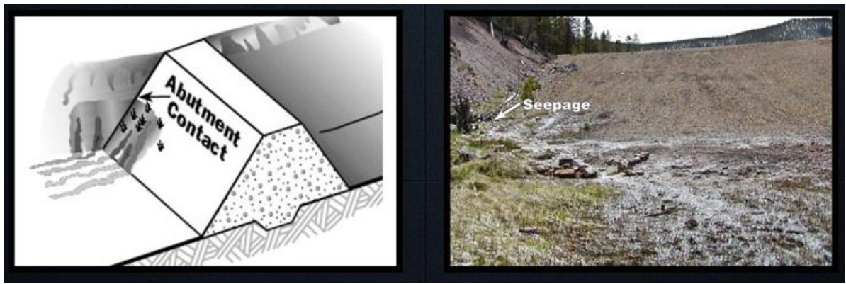
Figura 3-11 - Percolação na interface ombreira e maciço (Fonte: Website - US Department of Agriculture)
