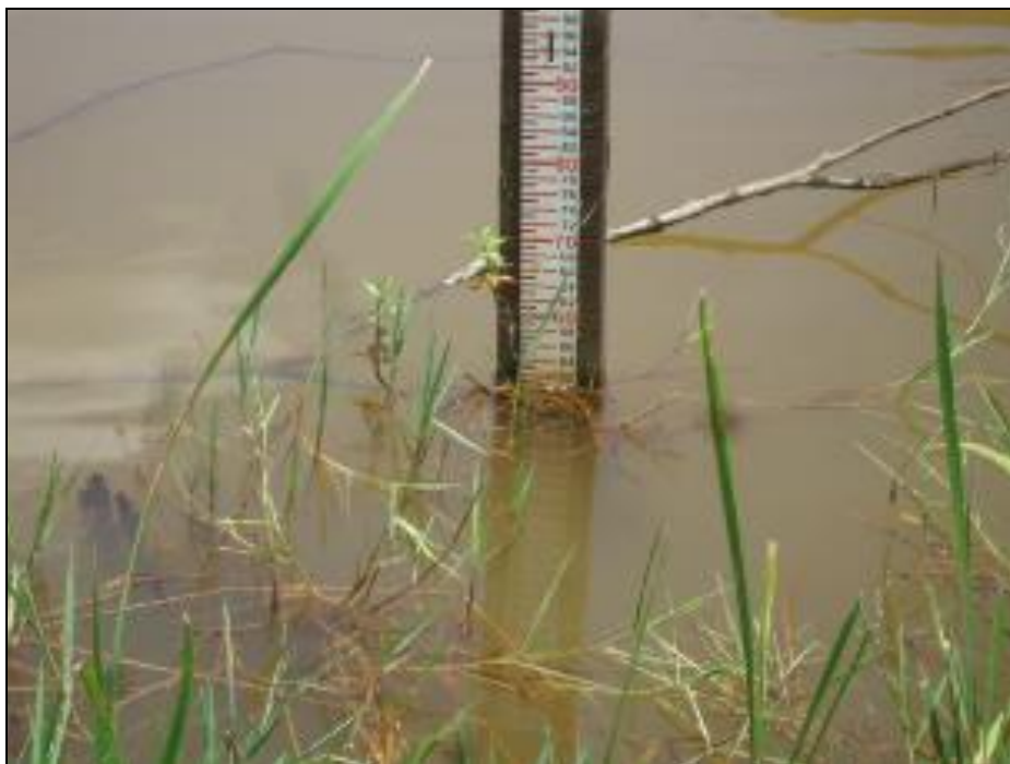
Figura 2-36 – Exemplo de réguas linimétricas para monitoramento do nível d'água de um reservatório (Fonte: O autor, 2016)
