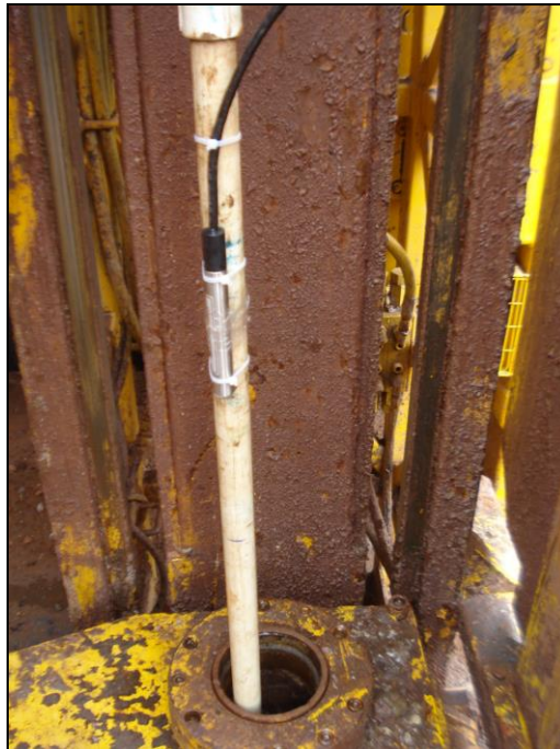
Figura 4-8 - Detalhe da fixação do sensor no lado externo do tubo (Fonte: O autor, 2015).
